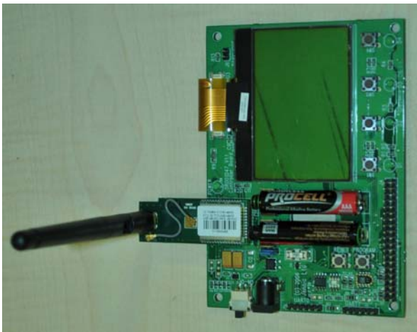
Şekil-7: Kontrol Ünitesindeki Kablosuz Alıcı Modül
