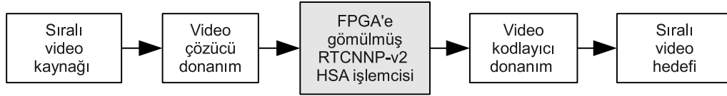
(a) Sistemin basitleştirilmiş blok diyagramı
