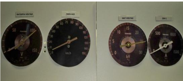
Şekil 9: Dinamik fren kullanıldığında gösterge durumları
