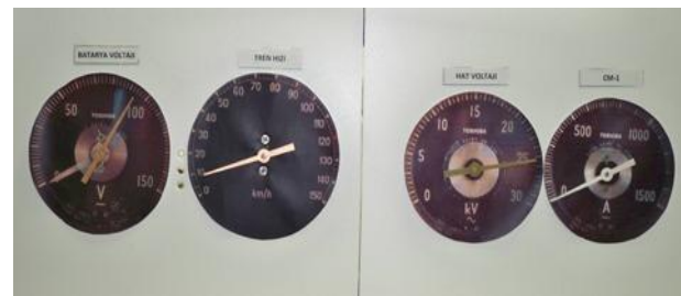
Şekil 12: Elektronik şalter arızasında ibrelü gösterge durumları
