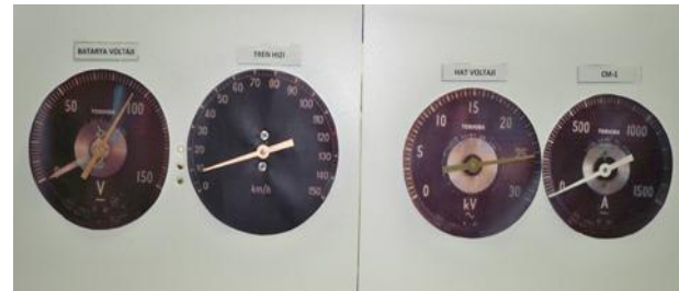
Şekil 12: Elektronik şalter arızasında ibrelü gösterge durumları
