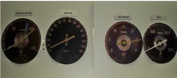
Şekil 9: Dinamik fren kullanıldığında gösterge durumları
